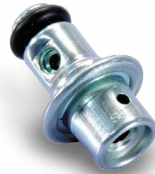
173.0001 TMAX 500 injection-iniezione 3,5 BAR
