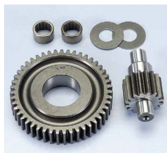
202.1402 Piaggio with bearing - con cuscinetto Z=16/47 Secondary ratio - Secondario
